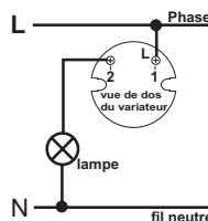
Illustration : Raccorder à la borne 1 (L) la phase de la tension d'alimentation 230V en CA.
