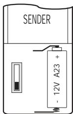
Nehmen Sie den Batteriefachdeckel der Fernbedienung ab.
